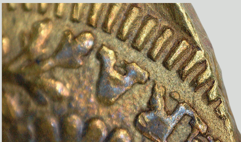
Figura 40 - Corrosão da superfície da barra Sabará N1635 (Nº Inv. 2416).
